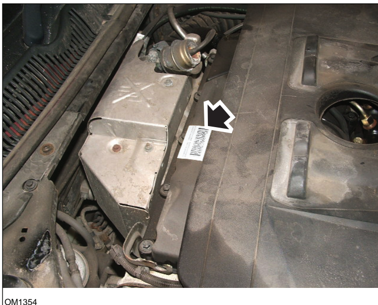
Moteur 2,0 TDCi - Étiquette de l'injecteur indiquée par une flèche sur l'illustration - Vue latérale
