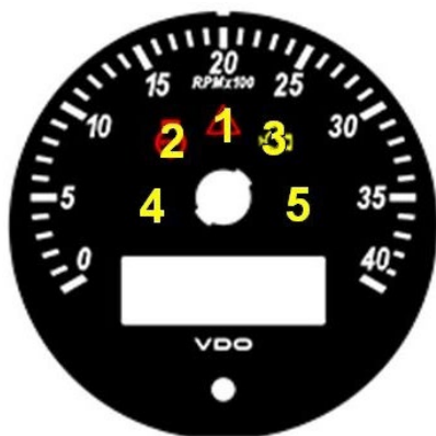
Fig. 4.4: assegnazione delle spie di avvertimento negli indicatori con diametro 80 o 100 mm.
