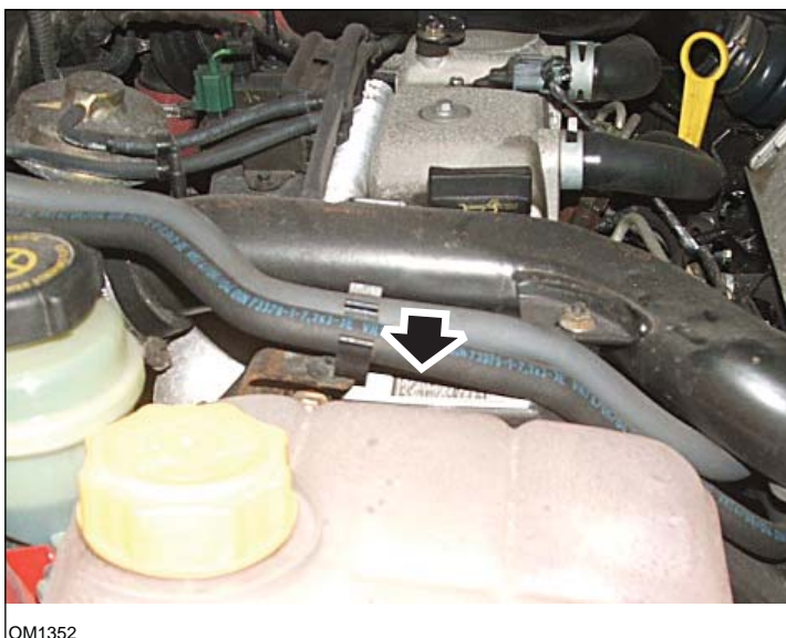
Motores 1.8 TDCi: - Etiqueta de inyectores indicada con una flecha: Vista lateral
