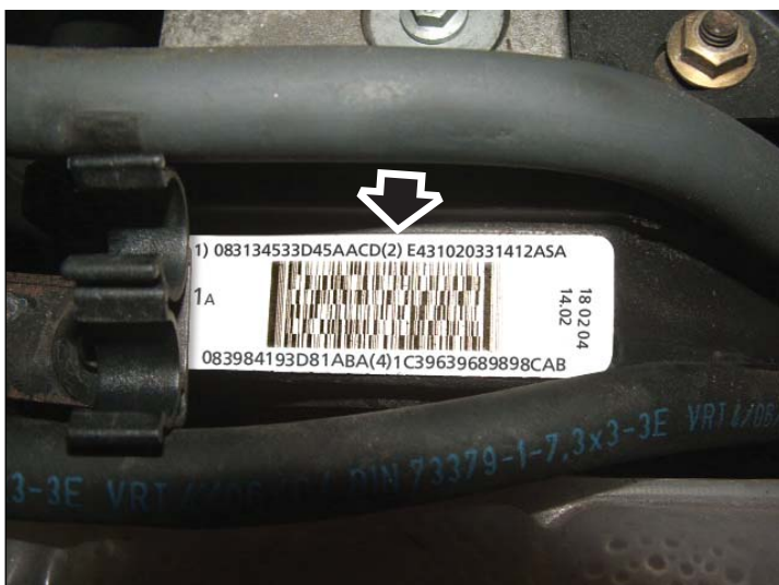
Etiqueta de inyectores y cabeza de inyector indicadas con flechas: Vista frontal
