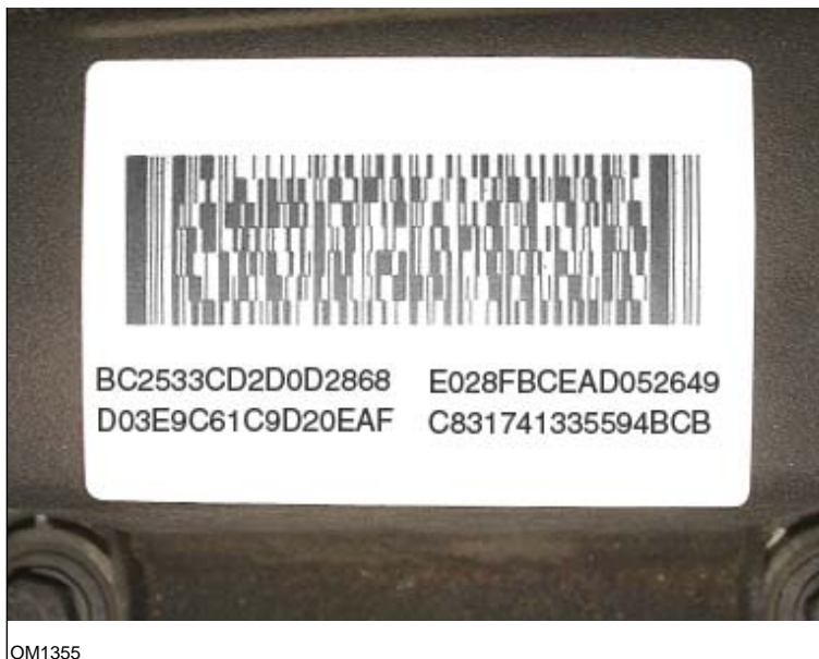
Etiqueta de inyectores: muestra cuatro números de 16 dígitos
