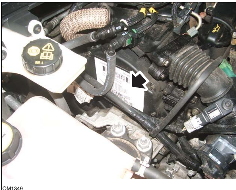
Motores 1.6 TDCi: - Etiqueta de inyectores indicada con una flecha
